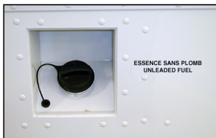
Fuel Fill Port
